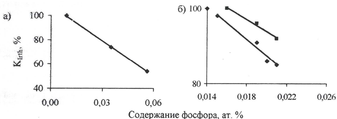
Рис. 2. Влияние содержания фосфора на снижение пороговых значений вязкости разрушения: а — плавки 1—3; б — кривая 1 — плавки 4—6; кривая 2 — плавки 7—11.
