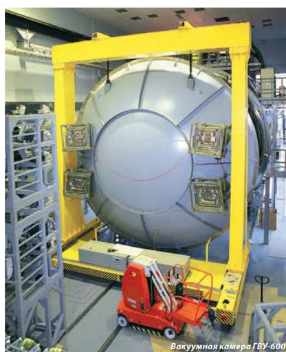
Рис. 5. Горизонтальная термовакuumная установка ГВУ-600
